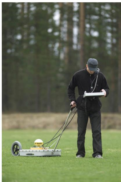
Il sistema georadar GPR X3M è caratterizzato dall'unità di controllo e dalle antenne schermate da 100 - 800 MHz.
